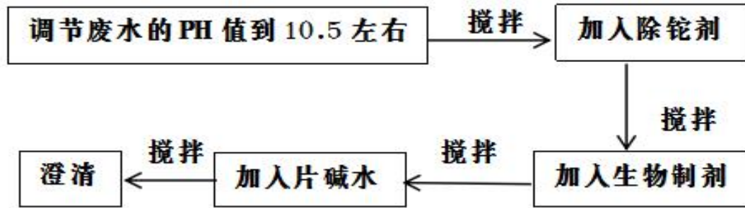
图1 含铊废水处理工艺
